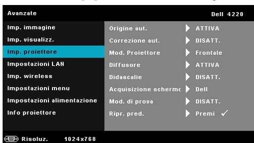
**ORIGINE AUT.**—Selezionare **Disatt.** (impostazione predefinita) per bloccare il segnale d'ingresso corrente. Se si preme il tasto Source quando la modalità **Origine aut.** è impostata su **Disatt.** si può selezionare manualmente il segnale d'ingresso. Selezionare **Attiva** per rilevare automaticamente i segnali d'ingresso disponibili. Se si preme il tasto **Origine** quando il proiettore è acceso, questo trova automaticamente il successivo segnale d'ingresso disponibile.
